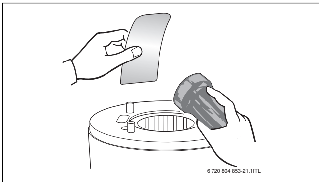
Rasm 52 Иссиқлик блокада қолдиқлар қолган-қолмаганлигини текширинг
