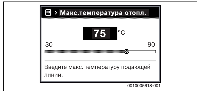
Рис. 58 Установка максимальной температуры подающей линии
